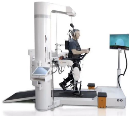
Figure 5 : Exosquelette Lokomat avec un support extérieur et un tapis de marche 38
