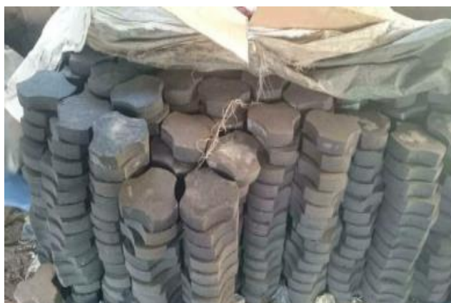
Figure 19 : Pavés fabriqués à partir du plastique recyclé. (Source : Kamgaing, 2021)
