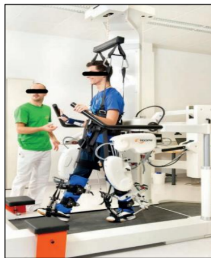
Fig. 9: Système robotisé pour la rééducation de la marche combinant un tapis roulant, une suspension partielle du corps et une orthèse motorisée Lokomat (Medidex)
