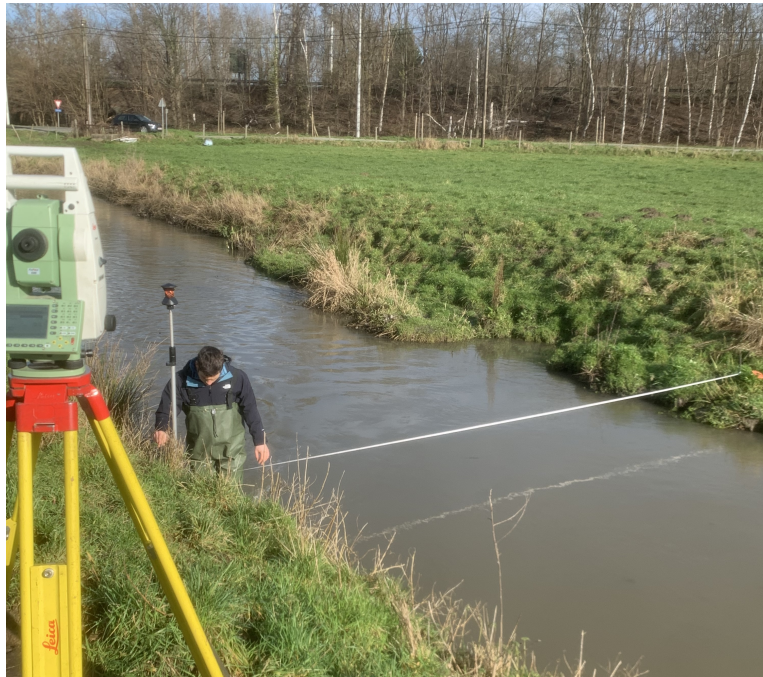
Figure 5.7 – Mesure de la bathymétrie en rivière à l’aide de la station Leica TPS1200 et d’un mètre ruban (Rosières).
