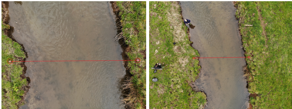
Figure 6.5 – (a) Image à l'altitude H . (b) Image à l'altitude H + \Delta H .
