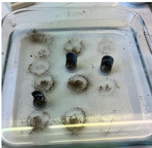
Figure 9 : Immersion des tubes PVC dans l'eau déminéralisée avec 3 échantillons testés pour maximiser la rapidité de la méthode USDA
