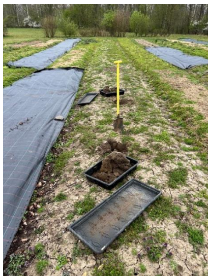
Figure 11 : Mise en œuvre de la méthode VESS, prélèvement des blocs de sol
