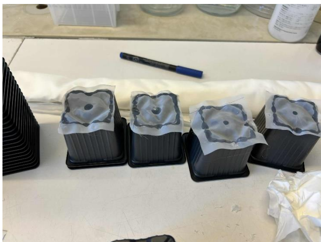
Figure 13 : Collage du file nylon sur les pots pour la mise en œuvre de la méthode du Most Probable Number (MPN)
