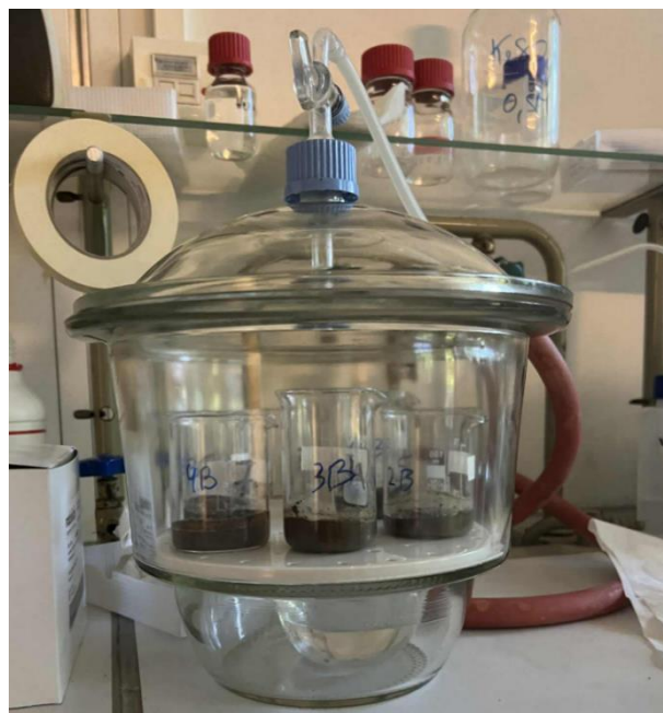
Figure 19 : Fumigation des échantillons durant la mise en œuvre de la méthode de dosage du carbone microbien par fumigation au \text{CHCl}_3
