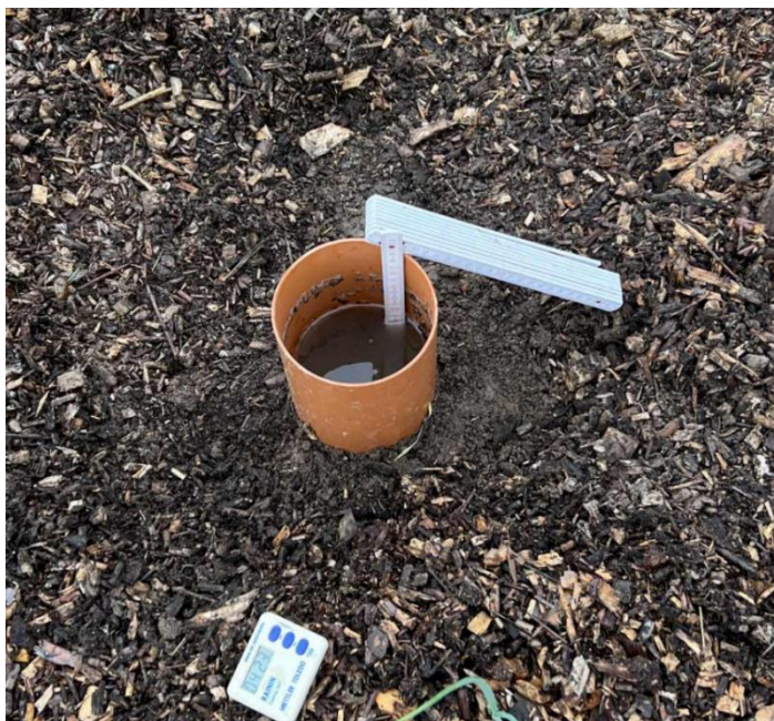
Figure 18 : Prise de mesure durant la mise en œuvre de la méthode dite « Ariane Chabert » sur paillage BRF
